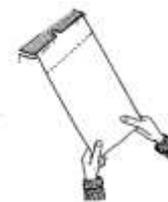
Ziehen Sie den Beutel mit beiden Händen gerade nach unten, bis sich die Nahtstelle (Perforation) des folgenden Beutels ca. 5 cm ausserhalb des Schlitzes befindet.
